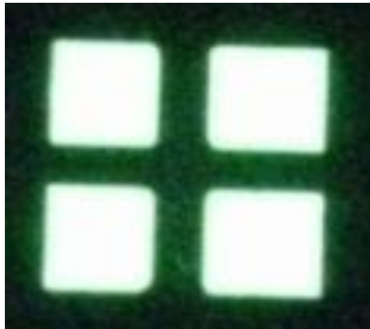
Hình 4.28. Ảnh OLED đang phát sáng (mặt trước): bốn OLED mắc song song với điện áp đặt vào 6 V [Nguyễn Năng Định, 2014].
