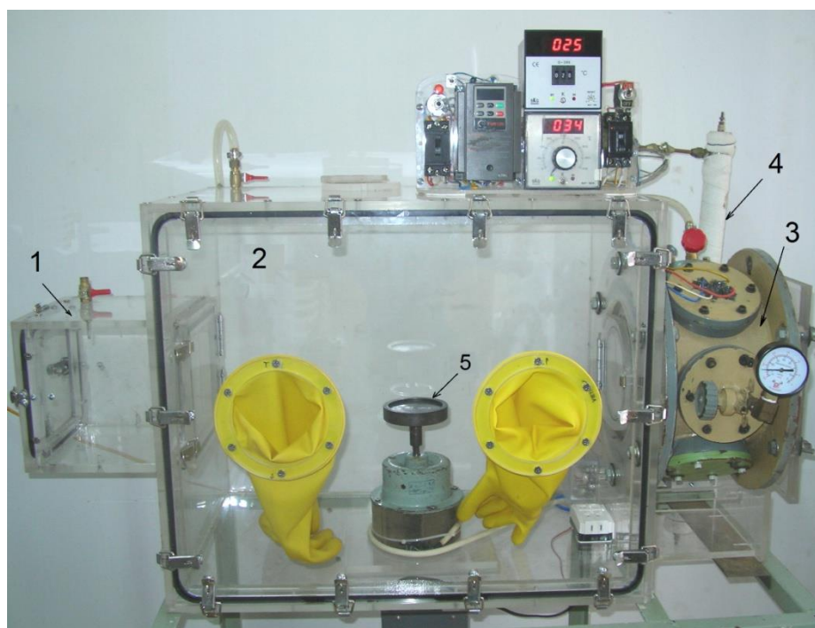
Hình 2.5. Buồng cách li (Glove-box): 1 - buồng đệm, 2 - buồng thao tác, 3 - buồng ủ nhiệt, 4 - bộ phận làm khô khí N 2 và 5 - bàn quay phủ
