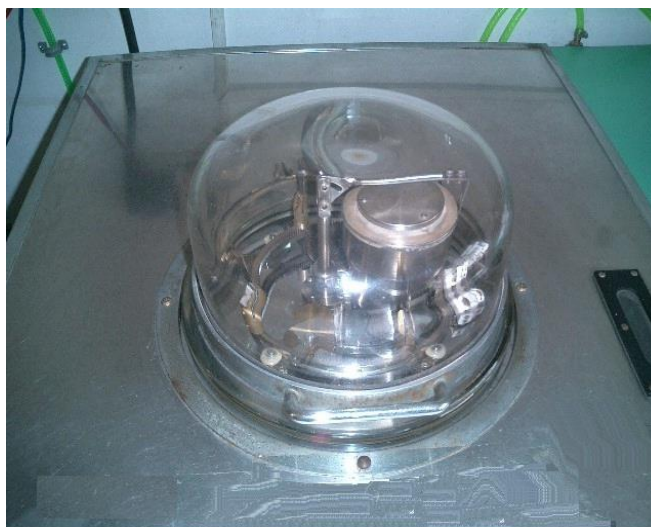
Hình 2.3. Hệ bốc bay chân không tạo điện cực kim loại
