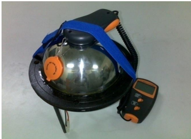
Hình 2.25. Hệ khảo sát độ ổn định OLED sử dụng quả cầu tích phân và máy đo độ rọi LX1010BS.
