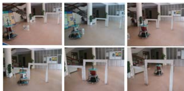
H. 14 Ảnh chụp liên tiếp chuyển động tránh vật cản của robot
