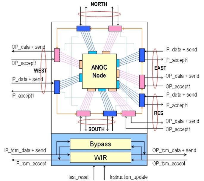
Fig. 4. ANoC-TEST wrapper.
