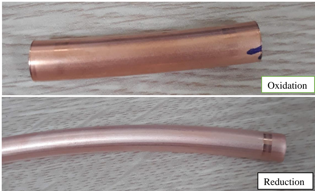
Hình 2. Phản ứng oxy hóa-khử (REDOX) làm thay đổi màu của ống đồng
