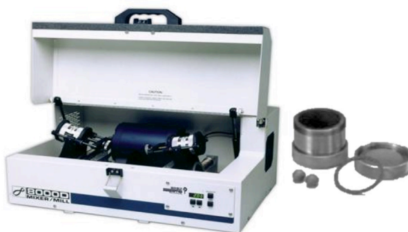
Hình 1. Hệ nghiền 8000D Mill/mixer và hệ cối 8004 tungsten carbide
