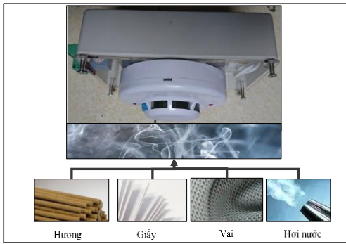
Hình 11 Sơ đồ khối phương án kiểm tra hoạt động của cảm biến phát hiện khói
