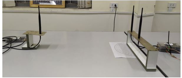
Hình 3. Thực nghiệm hệ thống xác định hướng sóng đến sử dụng SDR
