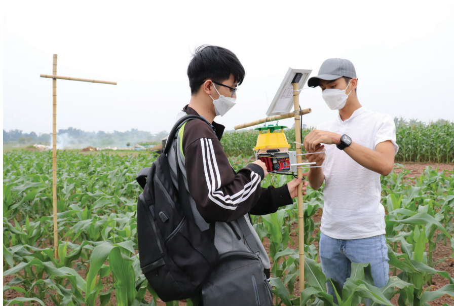
Lắp đặt hệ thống bẫy sâu keo mùa thu thông minh trên ruộng ngô, sử dụng truyền thông LoRa để truyền tải dữ liệu theo thời gian thực tại Việt Nam.
